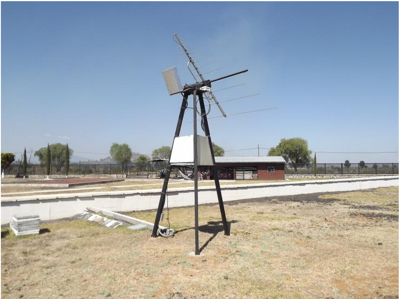
Fig. 2: Antenna with automatic positioning system at UNAM - Instituto de Geofísica unidad Michoacan Servicio de Clima Espacial – Mexico.
