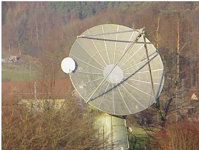
Fig. 1: 80cm Satellitenspiegel montiert an einem 5m-Spiegel im Radioobservatorium in Bleien AG. Das Observatorium mit der Empfangsanlage ist etwa 50m östlich von der Antenne (im Bild recht des Turmes).
