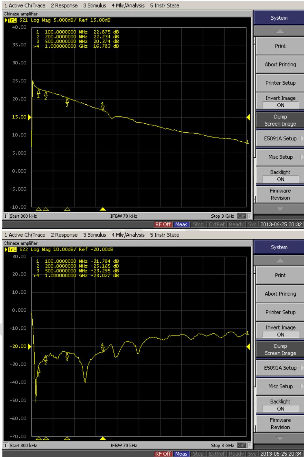
Figure 9 ~ CxLNA S-parameters
