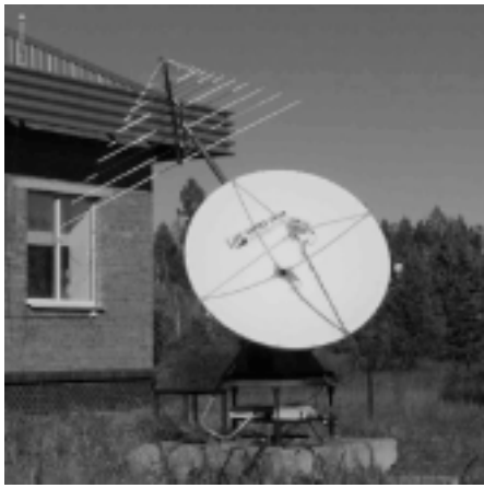
Fig. 1. Callisto log-periodic antenna.
